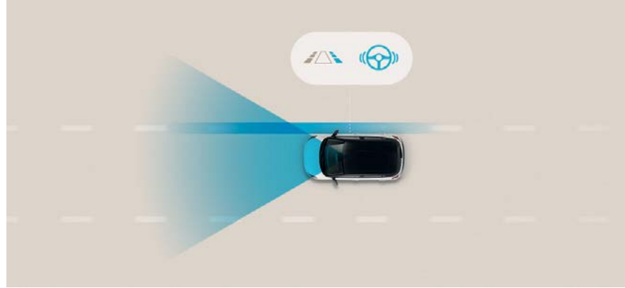
בקרת סטיה מנתיב + תיקון הגה (LKAS) סיוע אקטיבי בשמירה על נתיב הנסיעה, הכולל חיווי בלוח השעונים, התראה קולית ותיקון אקטיבי של נתיב הנסיעה.
