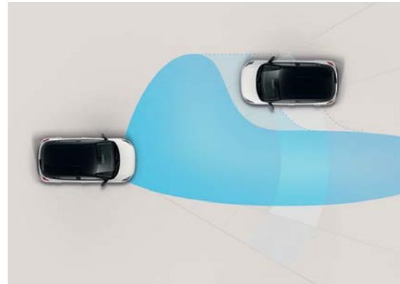
מערכת למעבר אוטומטי בין אור גבוה לנמוך (HBA) החלפה אוטומטית בין תאורת יום ללילה בהתאם לתנאי הדרך, מונעת סינוור רכבים ומגבירה את הבטיחות בנהיגת לילה.
